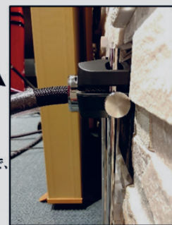
[After] NCF Boosterがコネクタを上下から、しっかりと固定するので、斜めに傾きません。
