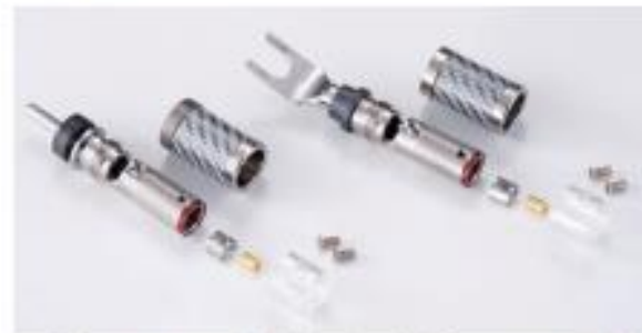
Yラグ「CF-201 NCF Plus(R)」(右)と、バナナプラグ「CF-202 NCF Plus(R)」(左)の内部。ボディを2ピースから1ピースとし、ボディ部内径の増加により、中心導体の先端の厚みを変更
